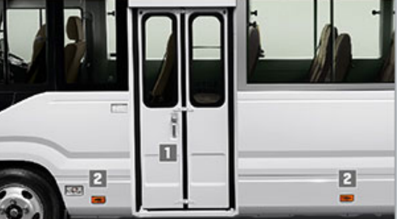
ระบบประตูไฟฟ้า พร้อมสัญญาณเตือน และป้องกันการหนีบ (Jam Protection)
