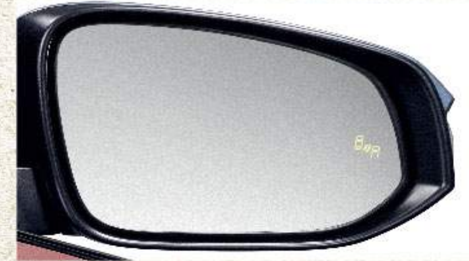
Blind Spot Monitor ระบบช่วยเตือนมุมอับสายตาที่ระจกมองข้าง
